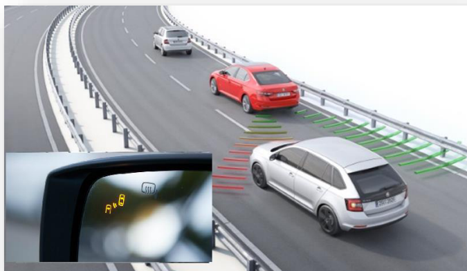
شکل 10: نحوه عملکرد سیستم پایش نقاط کور خودرو
